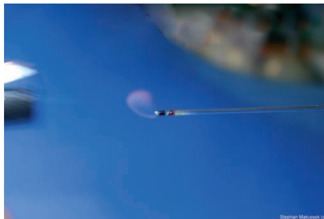
Abb. 10. Verbrennung von Schwefel im Kapillarröhrchen
