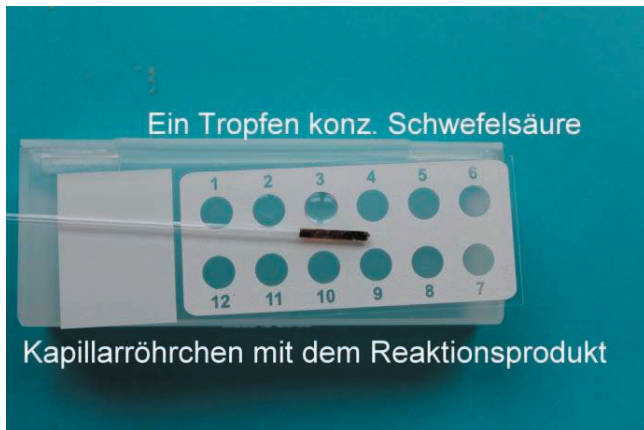
Abb. 29. Zuckerkohle in der Mikrokapillare
