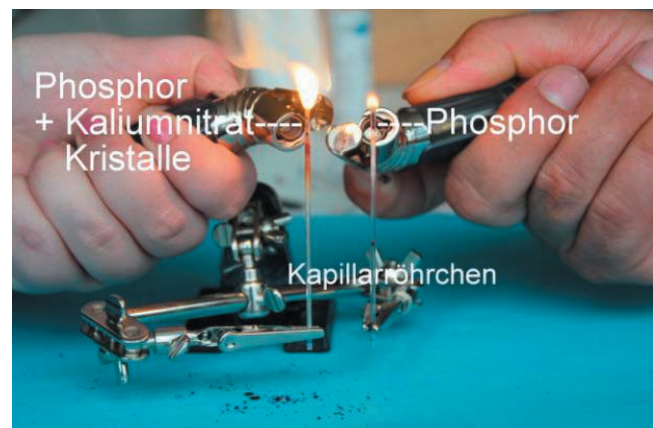
Abb. 16. Verbrennungen in reinem Sauerstoff im Kapillarröhrchenversuch
