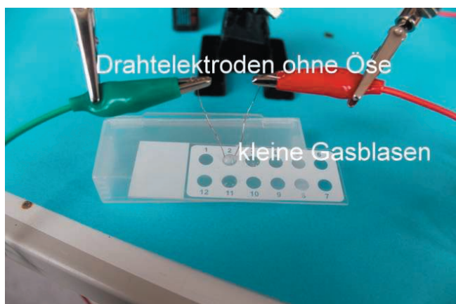
Abb. 17. Mikro-Elektrolyse von Wasser
