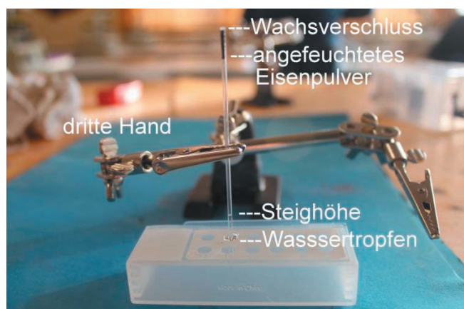
Abb. 13. Versuch zur Zusammensetzung der Luft
