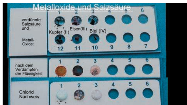
Abb. 25. Reaktion von Salzsäure mit Metalloxiden
