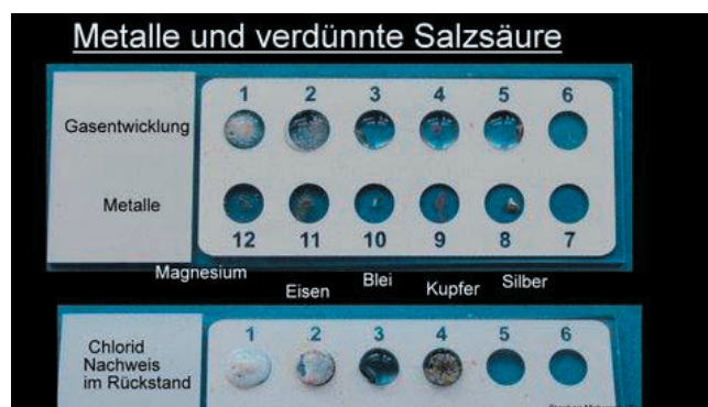
Abb. 24. Reaktion von Salzsäure mit Metallen
