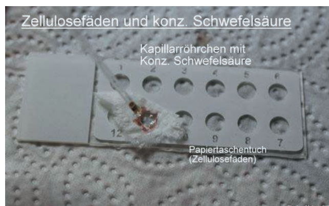
Abb. 28. Zellulosefäden und konzentrierte Schwefelsäure.
