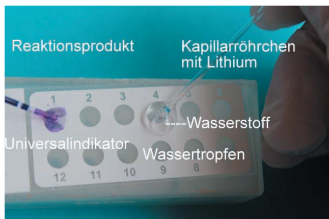
Abb. 27. Reaktion von Lithium und Natrium mit Wasser im Kapillarröhrchen-Versuch
