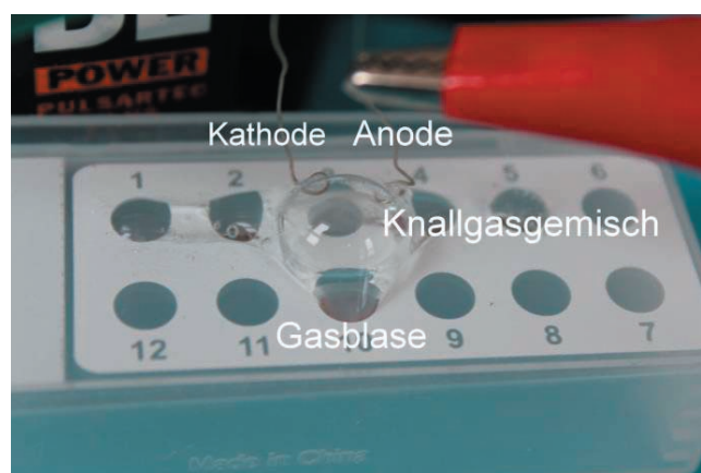
Abb. 20. Gasblase bei der Wasser-Elektrolyse
